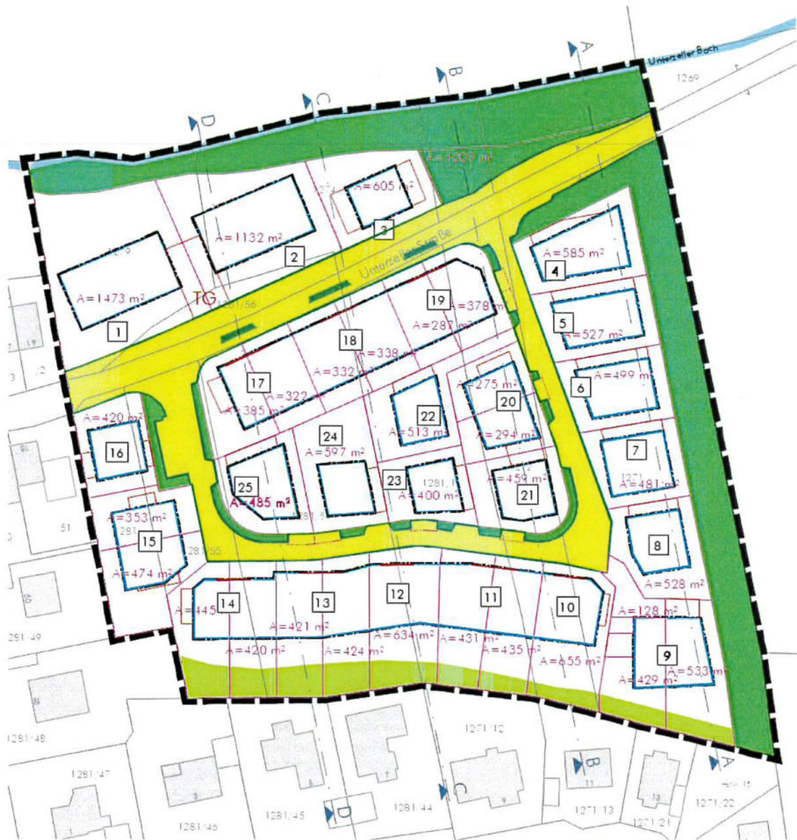
Abbildung 2: Vereinfachte Darstellung der Planzeichnung mit Schnittlagen, Indexzahlen und Grundstücksgrößen
